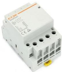
Alle 10 Klemmen des Schaltschütz lösen, die Kabel leicht nach hinten drücken und die Entriegelung des Schaltschütz (gelbe Lasche) leicht ziehen. Dann den Schaltschütz von unten nach oben von der Hutschiene abheben.
